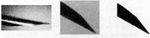
(a) 顺光下获取的输液针图像 (b) 逆光下获取的输液针图像 (c) 二值化后的输液针图像
